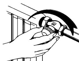
1. Снять защитный колпачок.
