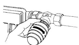
3. Умеренно затянуть вручную накидную гайку
