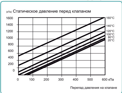
График перепада давления в начале кавитации (График №2)
