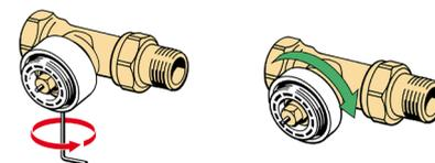
3. Наверните терморегулятор на переходник и затяните его от руки (момент затяжки не более 5 Нм).
