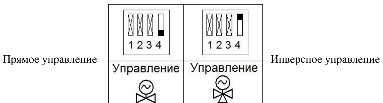
Рисунок 5 – Настройка направления управления
