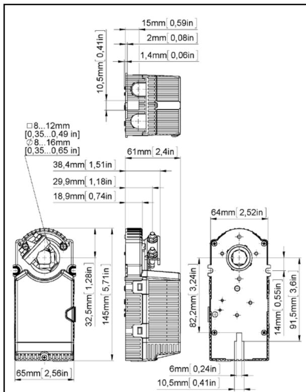
Montage/ mounting/montage/montaggio/ montaje / montaż:
