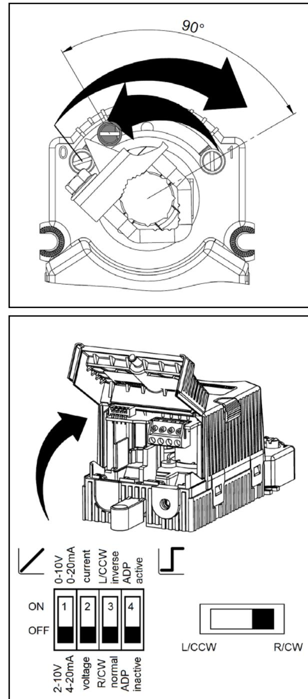
Anschluss/ connection scheme/ schema de connexion/ schema di collegamento/ esquema de conexiones / schemat podłączenia:
