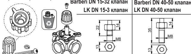
Прилагаемый монтажный комплект для клапанов ESBE, VRB, VRG, код 58037
