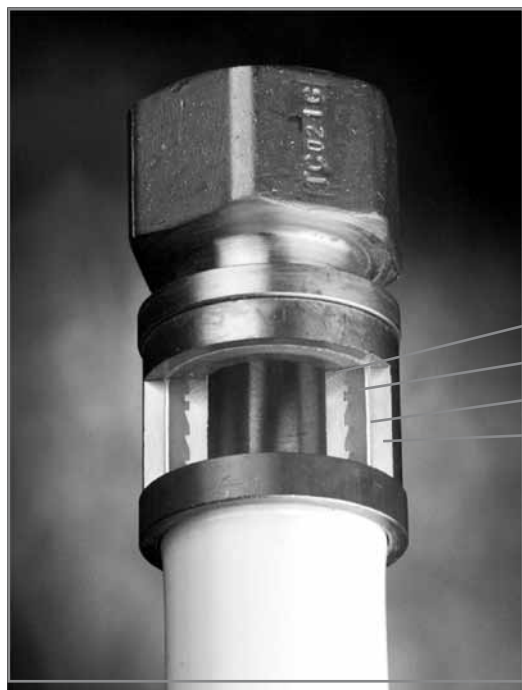
Фитинг Базовая труба Алюминиевый слой Пресс-втулка
