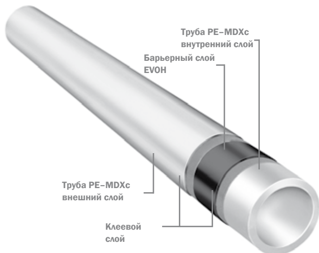
Структура трубы PE-MDXc TECOflex
