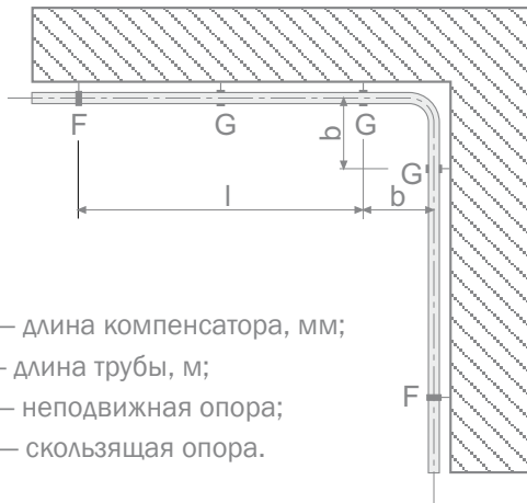
Пример оборудования компенсатора при смене направления трубопровода
