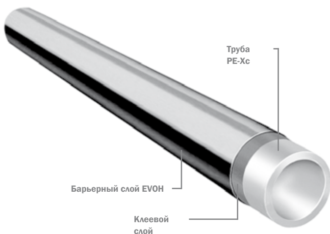
Структура отопительной трубы TECEflex
