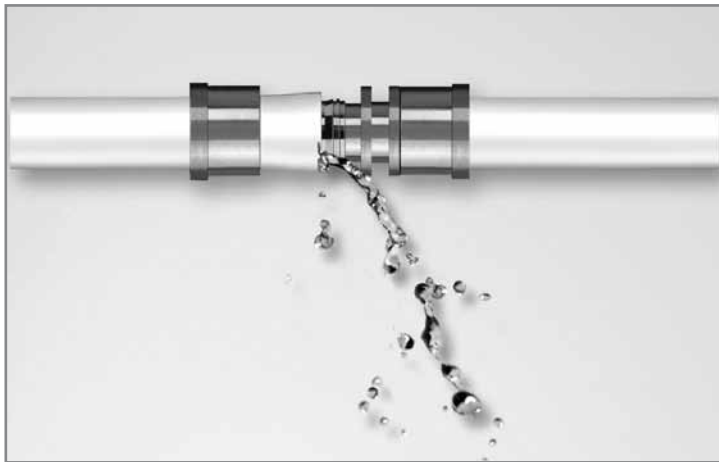
Утечка воды при неопрессованной пресс-втулке
